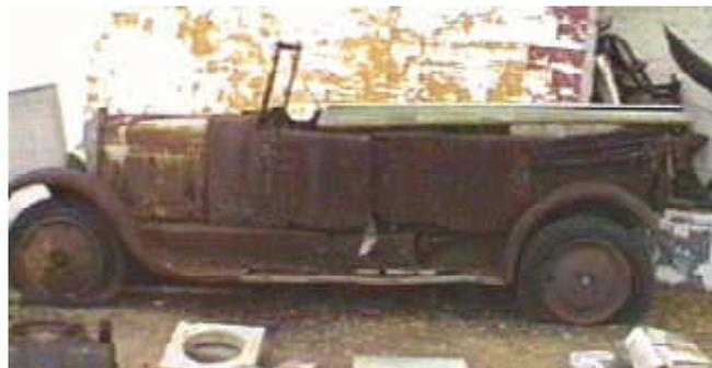
Der Motor ließ sich noch drehen, doch die maroden Polster und die auf Holzrahmen genagelte Karosserie war nur noch zum Teil zu retten. Die Bremsen wirkten nur auf die Hinterräder und die Handbremse wirkte auf eine Bremstrommel zwischen Getriebe und Kardanwelle. Per Hänger
